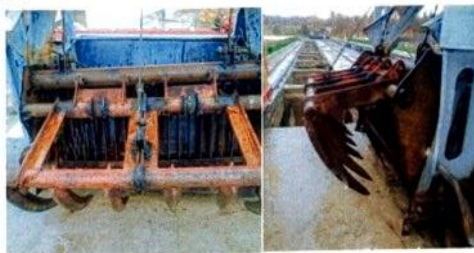
2-расм. Чиқиндиларни тозалаш қурилмасининг биринчи варианты.
