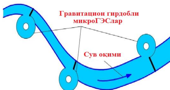
3-расм. Гравитацион гирдобли микроГЭСларнинг каскад тизимли чизмаси.
