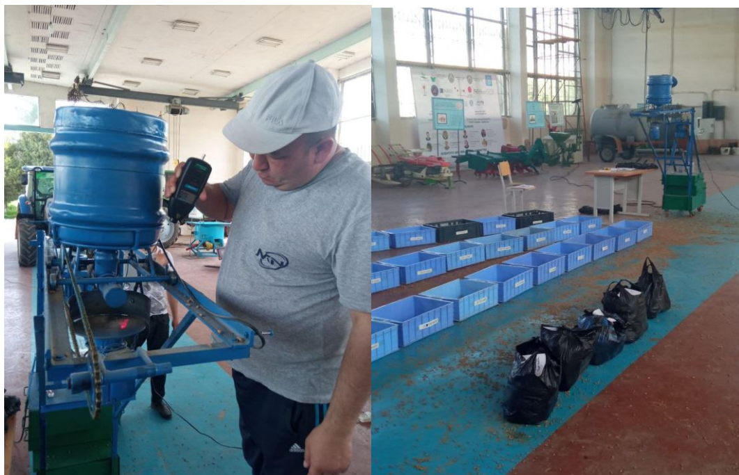
1-rasm Baliqlarga diskli ozuqa tarqatkich qurilmasi
