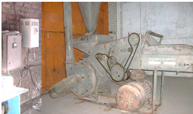
1-расм. Универсал ем майдалаш қурилмасининг асинхрон моторини частота ўзгартгич орқали бошқаришнинг умумий кўриниши
