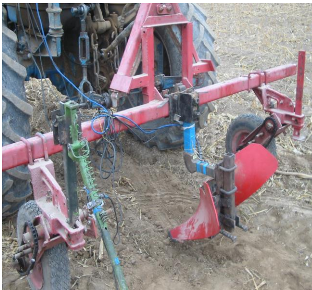
5.5-расм. Пушта ҳосил қиладиган ишчи қисмни судрашга қаршилигини аниқлаш учун тайёрланган махсус қурилма
