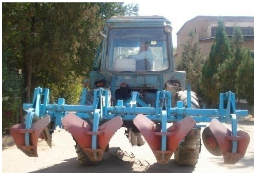
5.2.-расм. Ғўзапояли далаларда пушта ҳосил қиладиган комбинациялашган агрегатнинг кўриниши
