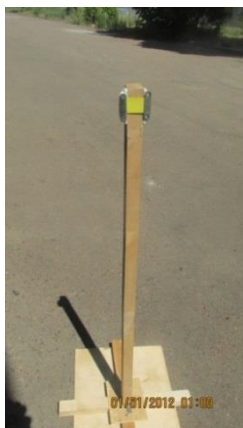
8.14-расм. Тўзиткичдан сепилаётган майда томчиларининг диаметрини аниқлаш учун махсус штатив ( a ) ва ўлчами 26x76 mm ли ишлов берилмаган ҳамда ишлов берилган суюқликни сезувчи 9950-0028 рақамли томчикартлари ( б ).
