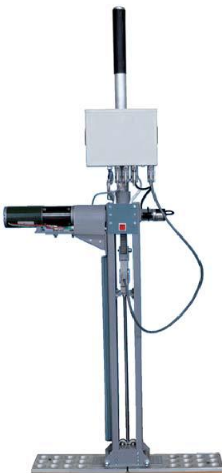
3.5-расм. ИП-271 русумли тупроқ қаттиқлигини электрон ўлчайдиган воситасининг кўриниши
