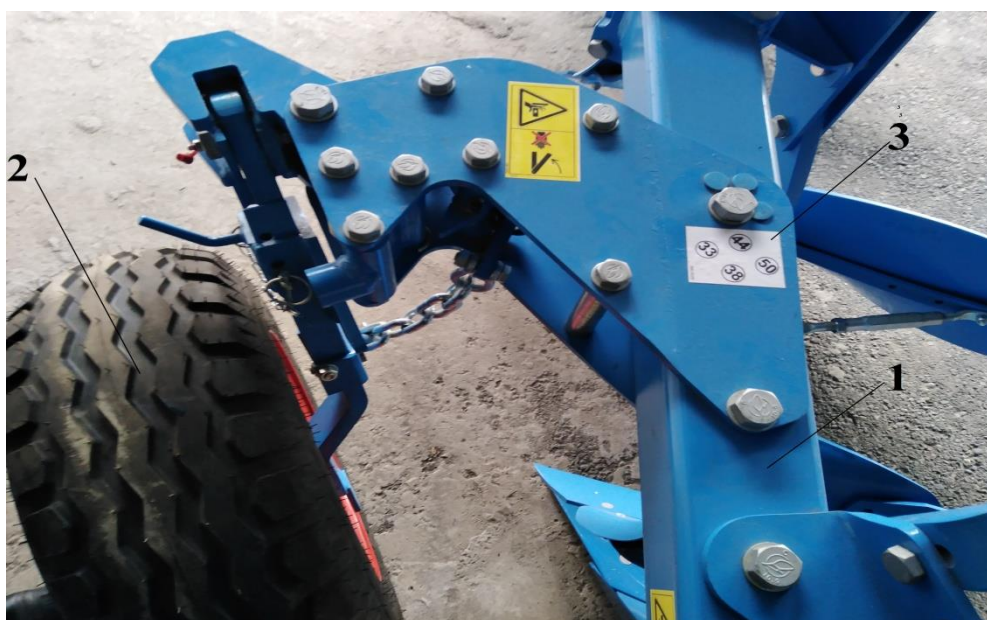
85-rasm. Plug tayanch g'ildiragi ustunini ramaga qotirish tartibini ko'rsatadigan raqamli jadval:
