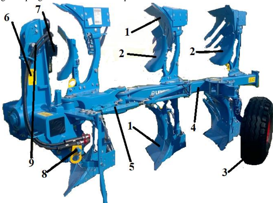
82- rasm. EurOpal 5 2+1 plugini umumiy ko'rinishi: 1 va 1' o'ng va chap tomonga ag'daradigan korpuslar; 2-chimqirqar; 3- tayanch g'ildirak; 4-rama; 5- Optiquick mexanizmlari; 6- plug ustuni; 7- plugni to'ntaradigan gidrosilindr; 8- pastki bo'ylama tortqilarni ulaydigan barmoq; 9- markaziy tortqi ulanadigan cho'ziq va dumaloq teshiklar:
