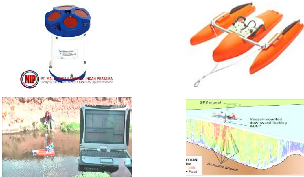
5-расм. Acoustic Doppler current profiler қурилмаси ва у билан сув сарфини ўлчаш
