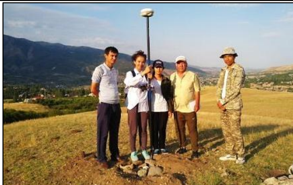
4-расм. Полигон ҳудудидаги таянч нуқтада GNSS ўлчашлар
