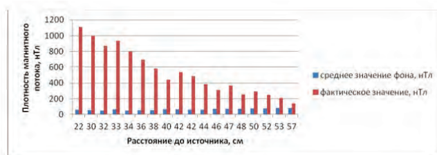
Рис.2. Распределение плотности магнитного потока в зависимости от расстояния до источника ЭМП в научной лаборатории №1.
