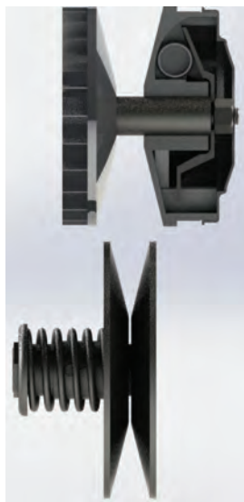
Рисунок 3. Сборка ведущего (сверху) и ведомого (снизу) шкива клиноременного вариатора
