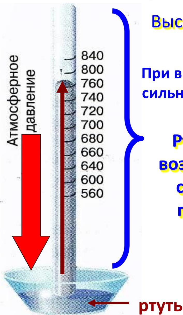
Высота перевёрнутой трубки = 1 м
