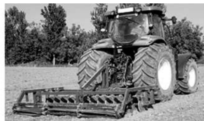
1-расм. Шудгорланган ерларга изма-из ишлов берадиган комбинациялашган машина
