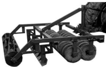
1-расм. Шудгорланган ерларга изма-из ишлов берадиган комбинациялашган машина
