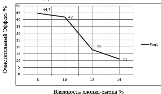
Рисунок 2. График зависимости очистительного эффекта сепаратора-очистителя с воздухопроницаемыми планчатыми барабанами от влажности хлопка-сырца.
