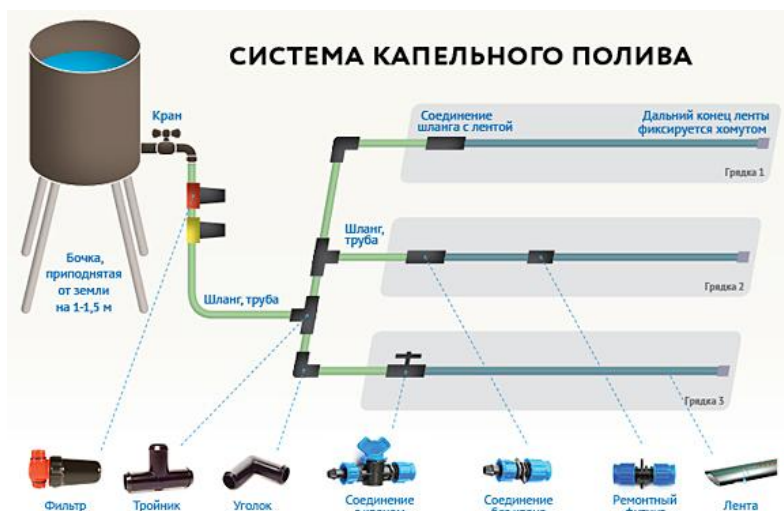
Рис.1 Общая система капельного орошения
