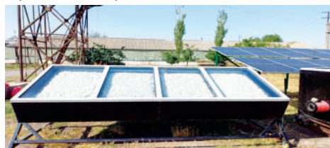
1-расм. Қуёш энергияси ёрдамида пиллалар ғумбагини жонсизлантирувчи қурилманинг такомиллаштирилган тажриба намунаси
