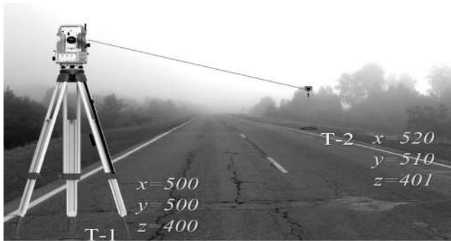
1-расм. Бошланғич маълумотларни киритиш ва тескари геодезик усулда координаталар аниқлигини баҳолаш жараёни.
