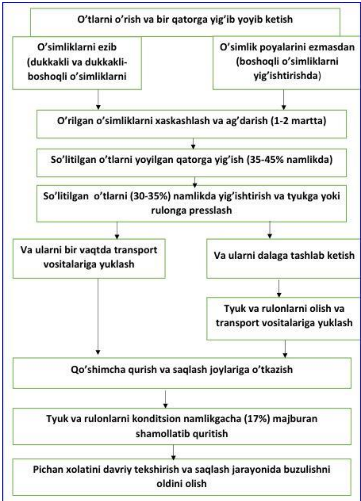
1.2-rasm. Presslangan pichan tayyorlash va saqlash jarayoni texnologik sxemasi
