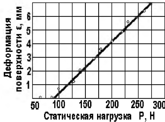
Рис.2. Остаточная деформация при воздействии статической нагрузки на плод дыни рабочей поверхности в виде цилиндра диаметром 50 мм и длиной 60 мм.
