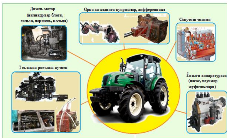
1-расм. Дизель моторли тракторнинг эксплуатациясида ишончлилик ва сифат кўрсаткичларига катта таъсир кўрсатадиган қисмлар.
