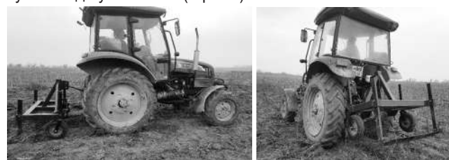
3-расм. Универсал илдизмева ковлагичнинг дала тажрибасини ўтказиш жараёни.
