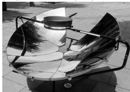
2-расм. Параболоид кўринишидаги концентратор [3].
