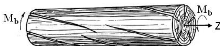
7.8-rasm. Doiraviy kesimli yog'ochning buralish deformatsiyasidagi buzilishi.
