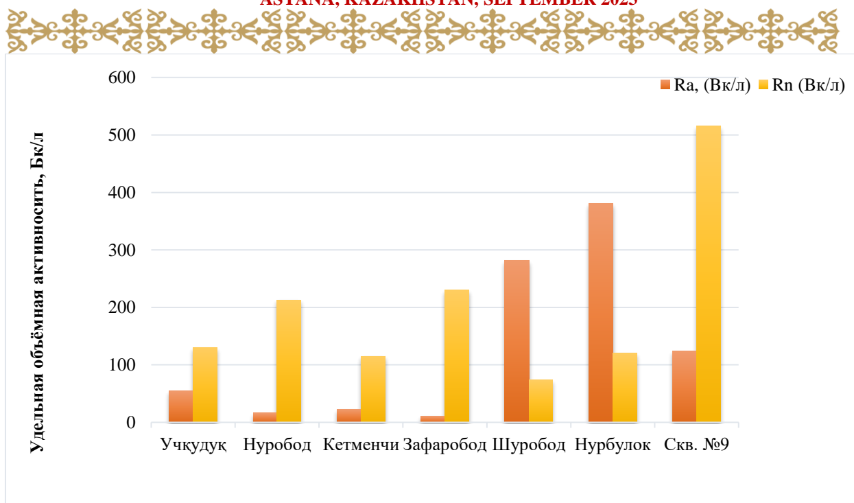
Рис 1. Изменение удельной активности радионуклидов ^{222}\text{Rn} и ^{226}\text{Ra} в одном, том же пробе отобранных из 7 источников подземных вод
