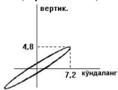
7-расм. Носозликни тузатилгандан кейин 2-насос агрегати электр моторида орқа подшипниги тебраниш траекторияси.
