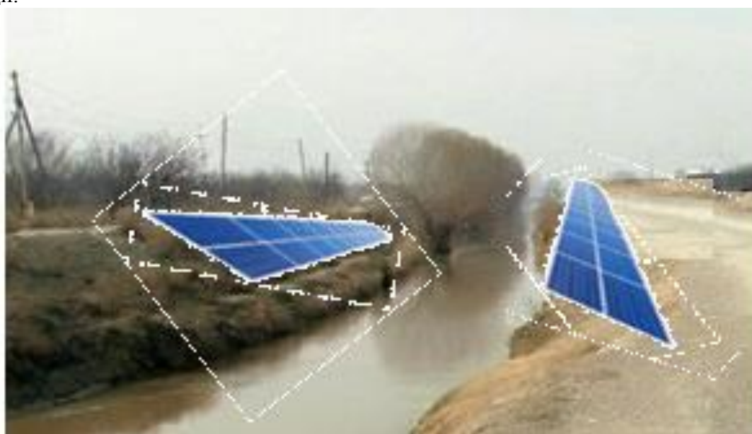
4-расм. Бевосита дала ёқасидан оқиб ўтадиган сув хавзаси бўйига кичик қувватли қуёш электр станцияларини қуриш. (мелиоратив тадбирларга халақит бермайдиган услубда)
