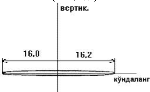
6-расм. 2-насос агрегати электр моторнинг орқа подшипниги тебраниши траекторияси (сиқилган таянч).
