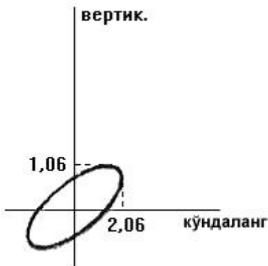
4-расм. Электр моторнинг орқа подшипниги тебраниш траекторияси (соз ҳолда).
