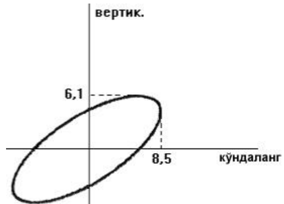
5-расм. Электр моторнинг орқа подшипниги тебраниши траекторияси (марказлашмаган).
