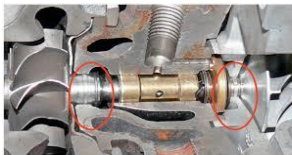
1.2-rasm. Kompresor valining yeyilishi ko'rsatilgan
