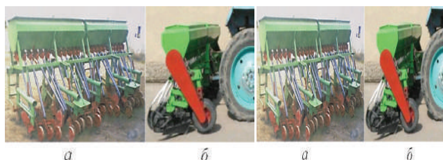
2-расм. Ѓўза қатор ораларига дискли экичга эга бўлган дон уруғини экувчи сеялалар
