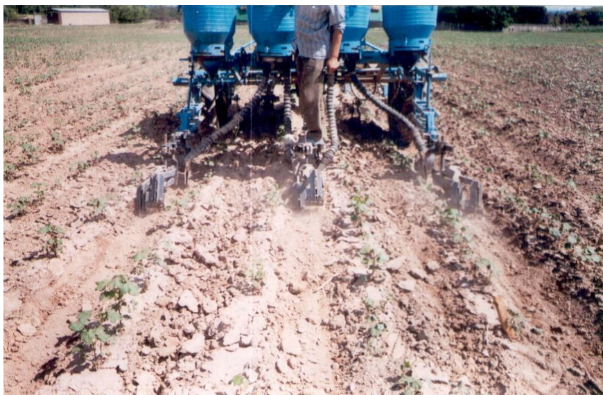
Рис. 2. Агрегат с навешенными на культиватор КРХ–4 специальными орудиями
