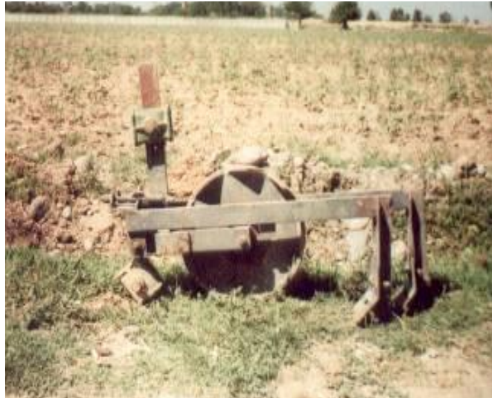
Рис. 3. Оборудование для нарезки зигзагообразных борозд
