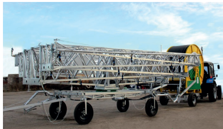
43-расм КД-63/86 ва КД-77/98 русумли прицепли консолли кўчма (мобил) ёмғирлатиб суғориш тизими
