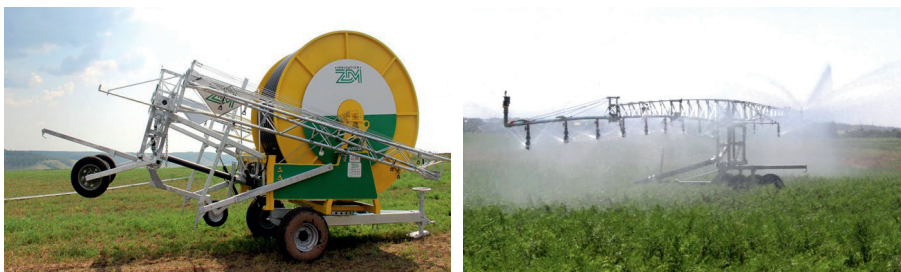
42-расм. Консолли кўчма (мобил) ёмғирлатиб суғориш тизими
