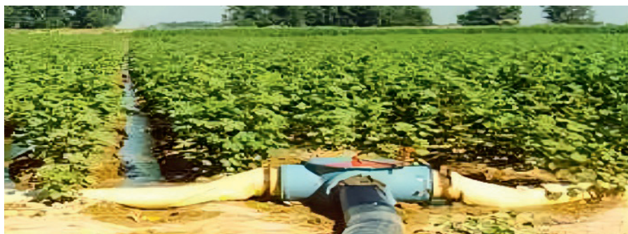
23-расм. Дискрет усулда суғоришда қўлланиладиган сувни очиб-ёпувчи қурилма
