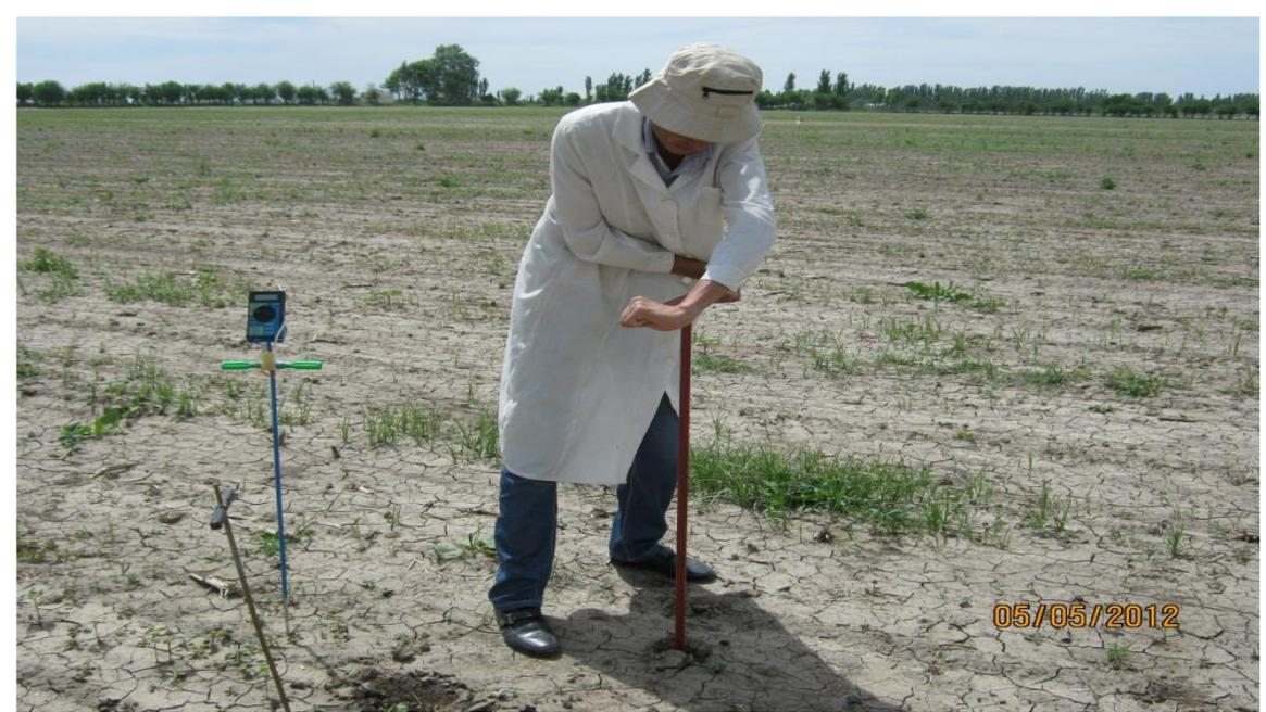
**Определение степени засоления образцов почвы и минерализации грунтовых вод, а также приёмка очищенных коллекторов**
