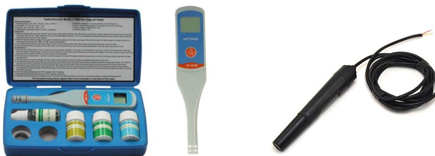
2-расм. а) QY-620 русумли pH – ўлчагичнинг умумий кўриниши б) Электр ўтказувчанлик датчиги
