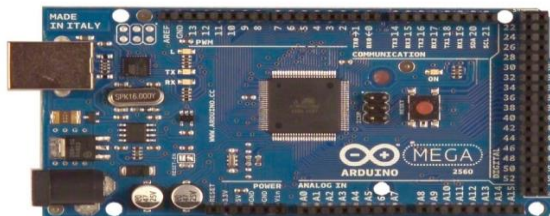
4-расм. а) ЛЭД ёритиш лентасининг умумий кўриниши б) Arduino Mega 2560 русумли микроконтроллер
