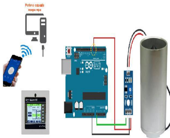
5-расм. Гидропоника усулида яшил озуқа етиштириш тизимини автоматлаштиришнинг тузилмаси а) Стационар бошқариш схемаси б) Масофавий бошқариш схемаси
