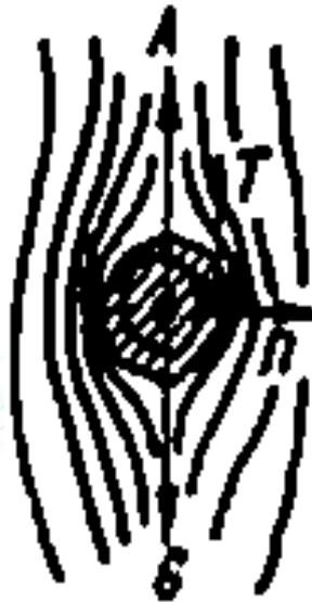
Рис.1. Силы, действующие на частицу в вязкой среде. А и сила трения Т.
