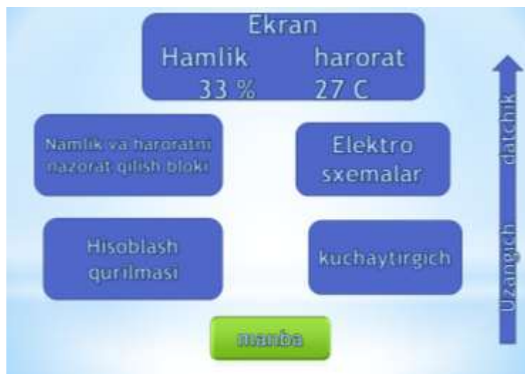
2-расм. Қурилманинг схемаси.
