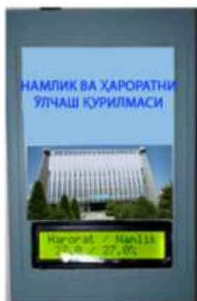
1-расм. Намлик ва ҳароратни ўлчаш қурилмаси умумий кўриниши
