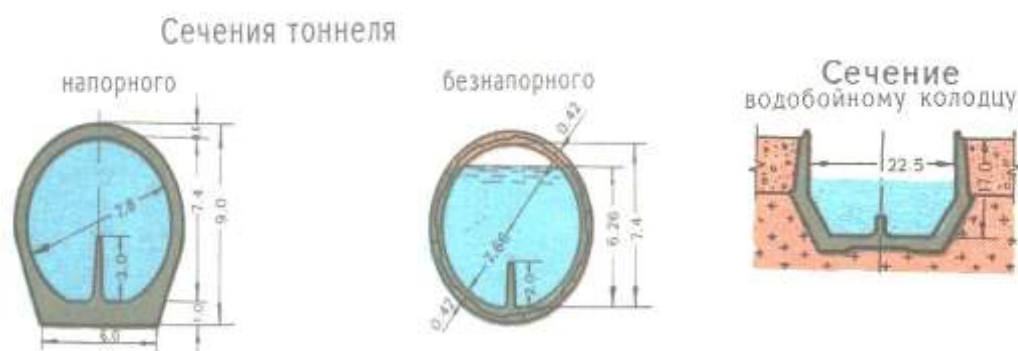
1-расм. Босимли, босимсиз ғорларнинг ва сув тушиш кудуғининг кўндаланг кесими (ўлчамлари билан) [2].
