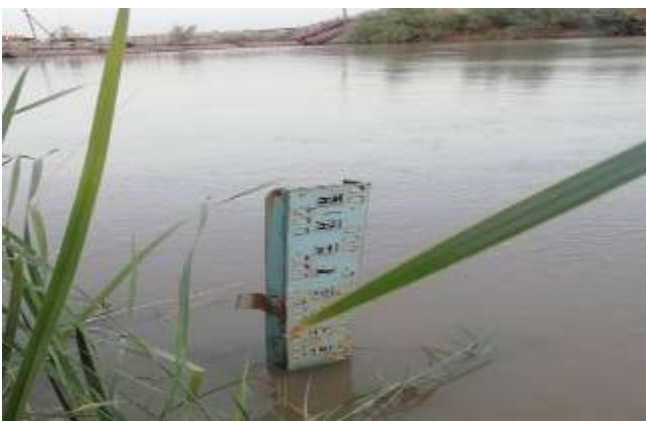
2-расм. Сув сатҳини ўлчаш рейкаси.
