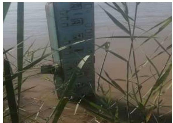
2-расм. Сув сатҳини ўлчаш рейкаси.
