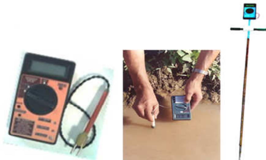
45-rasm. Tuproqni sho'rlanishini elektr o'tkazuvchanlik bilan aniqlash
