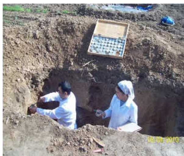
9-rasm. Azot, fosfor, kaliy va gumusning yalpi miqdori uchun namuna olinmoqda.
