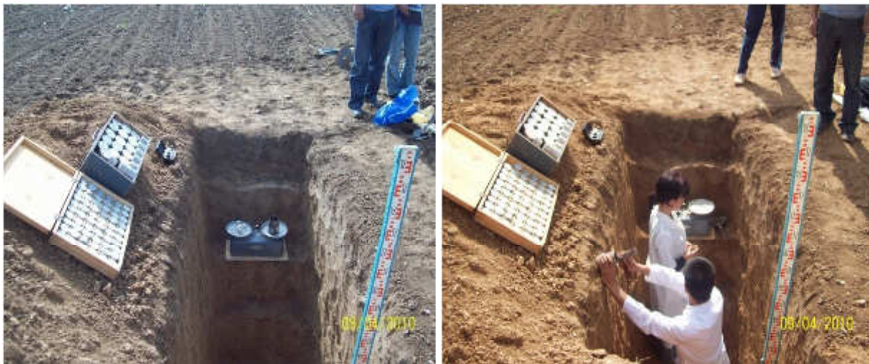
10,11-rasm. Tuprog'ining hajm og'irligi, solishtirma og'irligi, g'ovakligi va mexanik ko'rsatkichlari bo'yicha namunalar olish.
