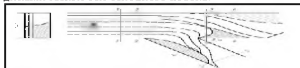
Рисунок 1. Вид трансформации донных и поверхностных линий токов при делении потока в бесплотинном водозаборе АБМК
