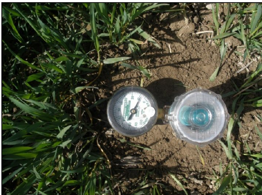
59-rasm. Tenziometrlar yordamida tuproqning namligini aniklab qishloq xo'jalik ekinlarining sug'orish muddatlarini aniklash
