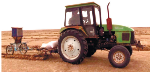
4-расм МТАга тиркалган универсал экиш аппарати эга инновацион сеялка билан саксовул ва черкез ўсимликлари уруғларини экиш жараёни
