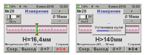
После завершения автокоррекции нуля прибор вернется в режим измерения.
