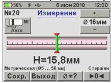
г) Зафиксируйте прибор на поверхности в неподвижном состоянии и нажмите кнопку «**Coxp.**» для сохранениярезультата измерения **H**.
