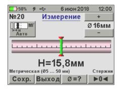
При совмещении центра линейного индикатора с указателем положения оси арматуры указатель примет зеленый цвет — арматура обнаружена и находится под цен- тральной продольной осью прибора. Если при этом активен режим акустического поиска, частота тонального звукового сигнала станет максимальной.
