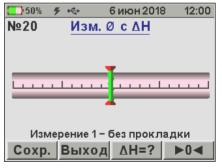
д) Затем установите прибор в то же место через диэлектрическую прокладку и снова нажмите кнопку «**Coxp.**».
