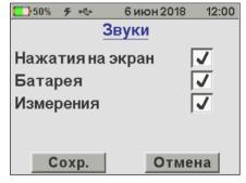
**Примечание** — Акустический поиск удобен при по- иске арматуры и сканировании изделий в труднодоступных местах: с приближением датчика к арматуре частота тонального звукового сигнала повышается и становится максимальной, если центральная продольная ось датчика прибора будет расположена над осью арматурного стержня.
