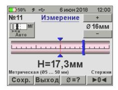
**Примечание** — Установленное значение диаметра арматуры при построении сетки армирования не влияет на результат.
