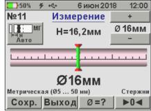
$\Gamma$ ) Для сохранения результата измерения в архив и использования полученного значения диаметра в после- дующих измерениях толщины защитного слоя бетона **H** нажать кнопку «**Coxp.**».
