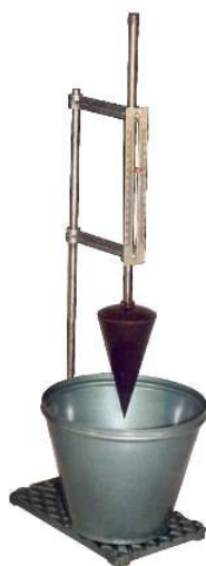
3 – расм. Строй ЦНИЛ конуси. ГОСТ 5802-86 бўйича қоришманинг қўзғалувчанлиги текшириш лаборатория жихози
