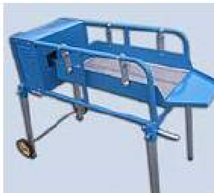
2-расм. SS-370 ХХР да ишлаб чиқарилган вибрацион ҳаракатли элакнинг кўрини. 1. Коробка. 2. Вибратор. 3. Сеткали каркас (сетка ҳолаган диаметрга алмашадиган). 4. Рама. 5. Вибро изоляция. 6. Қопқоқ. 7. Герметик ёпгич.
