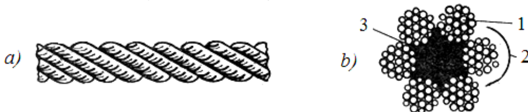
1.5-rasm. Po‘lat arqon: a -bo‘ylama ko‘rinishi; b -ko‘ndalang kesimi; 1-sim; 2-simlar o‘rami; 3-o‘zagi.
