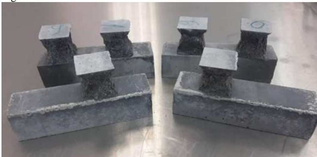
4-rasm. Sement namunalarining siqilishga bo'lgan mustahkamligini aniqlash
