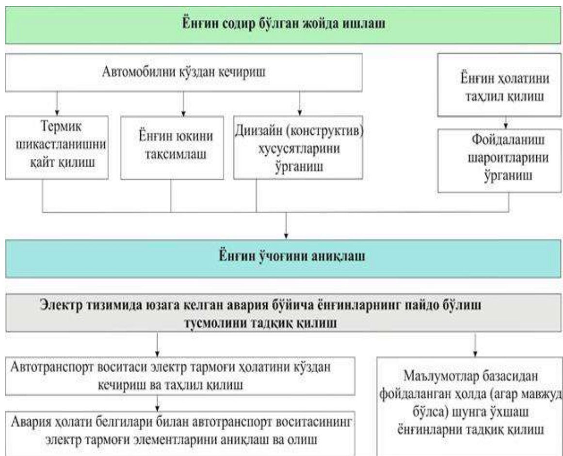
1-расм. Ёнғин содир бўлган автомобилни ва унинг электр тизими ҳолатини кўздан кечириш
