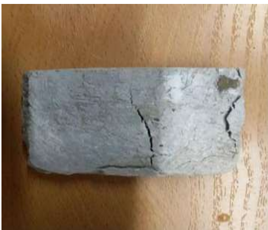
2-расм. Янги олинган кальций силикатли плиткали материалларни синалган намуналари.
