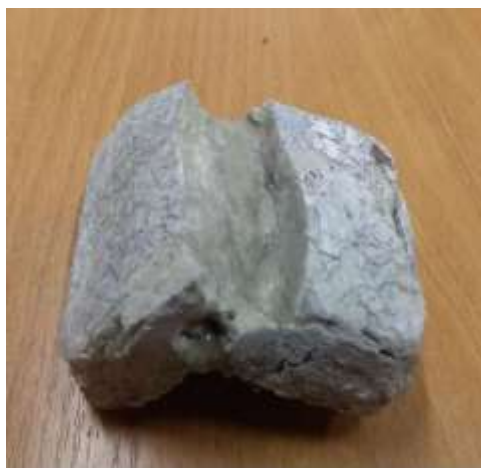
2-расм. Янги олинган кальций силикатли плиткали материалларни синалган намуналари.
