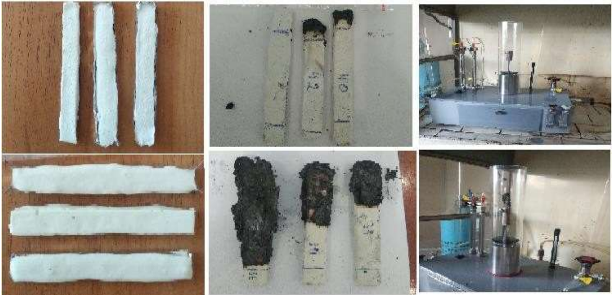
1-расм. Ёнғиндан ҳимояловчи қавариқланадиган полимер композит қопламаларни кислород индексини тадқиқ этишнинг лаборатория жараёнлари
