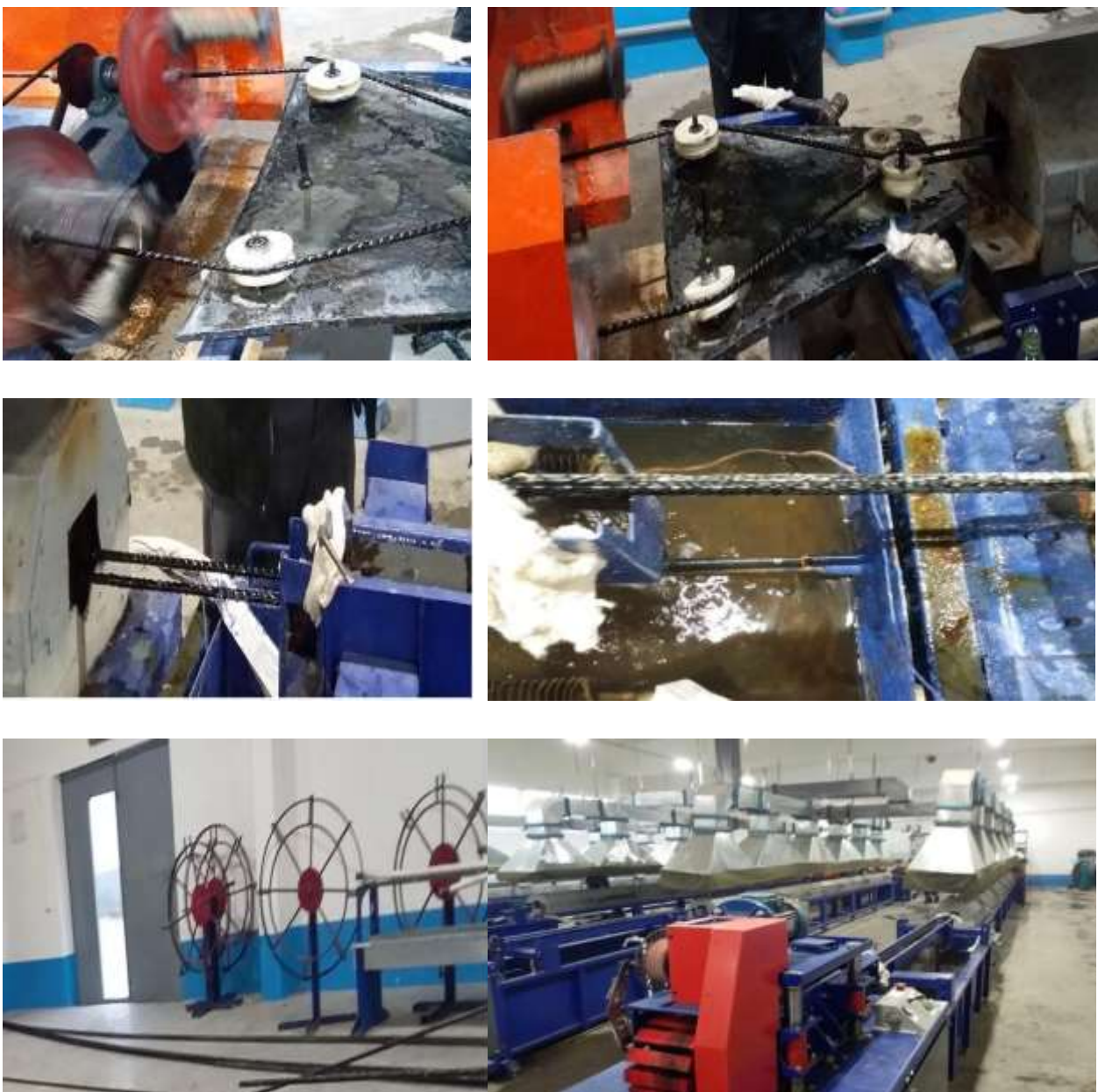
3-расм. Жиззах вилоятидаги “Базальт” корхонасида базальт композит арматураларни ишлаб чиқариш жараёнлари.
