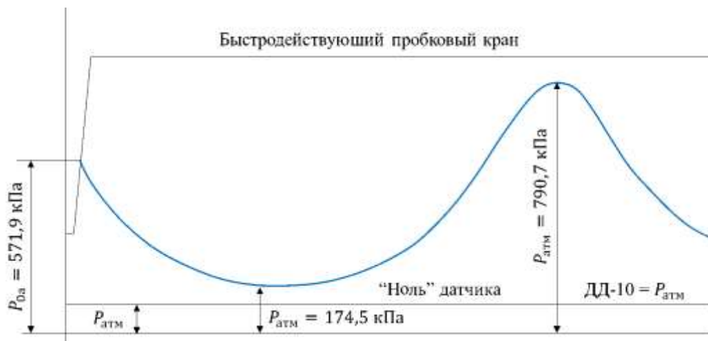
Рис.6. Диаграмма колебания давления в гасителе без диафрагмы при гидравлическом ударе с понижением давления (по датчику Д-1, r_k=21 ):
