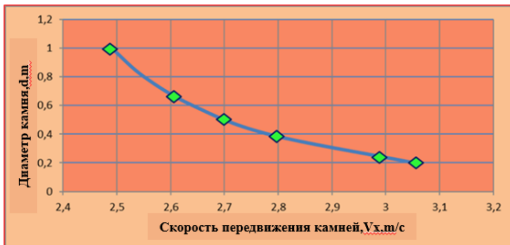
Рис. 7. Скорость передвижения камней в водоподводящем русле Лангарского селе-водохранилища
