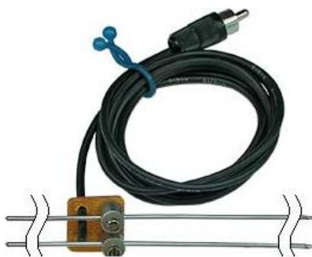
11.4-rasm. Tuproqning namligini(uning qarshiligi orqali) o‘zgaruvchan tokda o‘lchash uskunasi tashqi ko‘rinishi.
