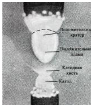
2.11-rasm. Yoyli razryad hosil qilish sxemasi va jarayoni
