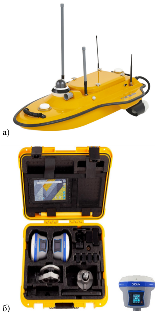
Рис. 1. Используемые инструменты. а) Беспилотный плавательный аппарат – Chsnap apache 3 , б) GPS оборудования GNSS I 90
