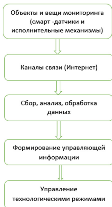
Рисунок 3. Блок-схема алгоритма функционирования системы на базе «Интернета вещей»
