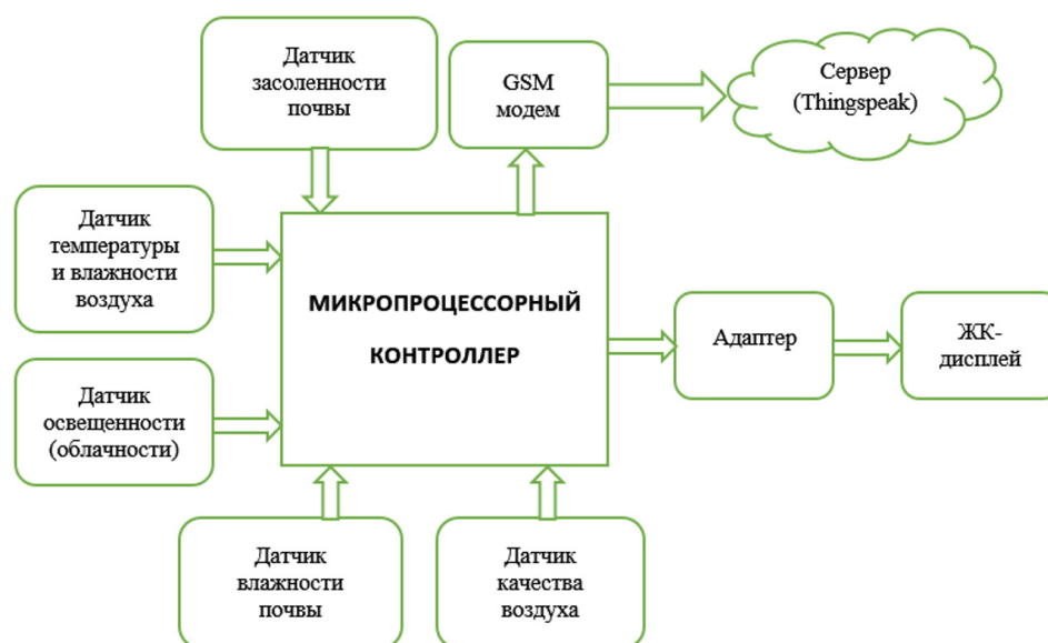
Рис. 1. Блок-схема интеллектуальной системы мониторинга процесса полива на основе IoT
