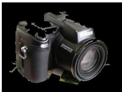
Отсу усули PSNR= 15.1286 MSE=1996.2537 SSIM=0.8047
