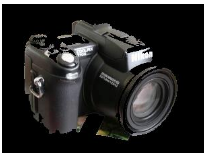
Адаптив бўсағалаш усули PSNR= 15.9282 MSE=1660.5649 SSIM=0.7813
