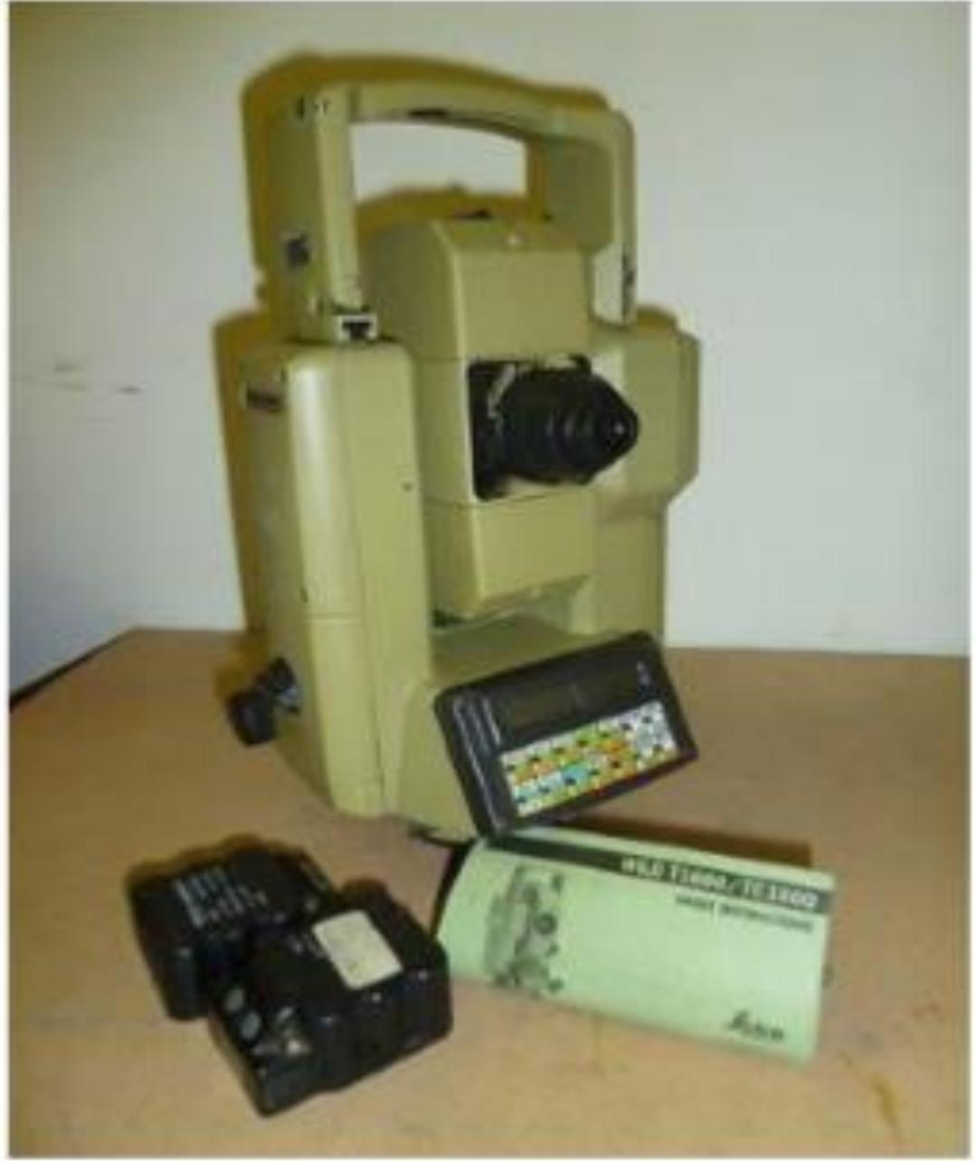
Үлчашниг кодли системаларида оптик системаларидаги каби, үлчанувчи микдор бевосита лимбдан саналади. Wild TC (Leica Geosystems AG) электрон тахеометрлари ва уларнинг модификациялари, ҳамда ТС 600 Е ва ТС 400 Е (Геодезик асбоблар. Екатеринбург) тахеометлари кодли системаларга эга. Бу асбобларда үлчаш системаси лимбдан ташкил топган бўлиб, унга иккилик код туширилган, ёруғлик диоди ва оптик системалари фотодиодли матрицада доира бўлакларининг тасвирини шакиллантиради.
