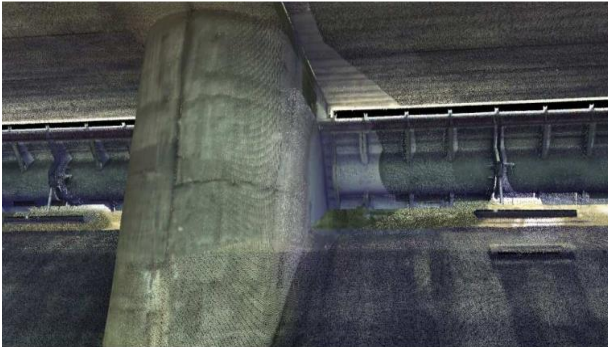
Besko to`g`onining o`lchash ishlari natijalari-suv oqib chiqish xuududidagi to`g`on modeli
