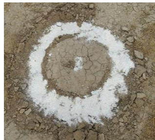
Рис.6. Маркировка плано-высотного опознака вне населенных пунктов справа- фотоабрис, слева- аэроснимок
