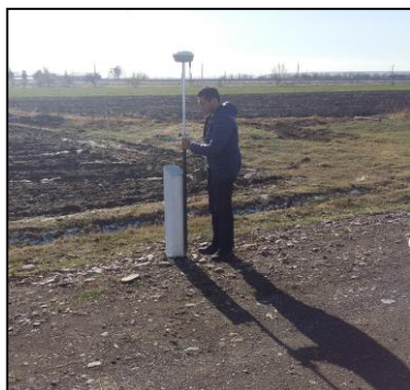
Рис.4. Плано-высотный опознак в населенных пунктах слева – фото абрис, справа - аэроснимок
