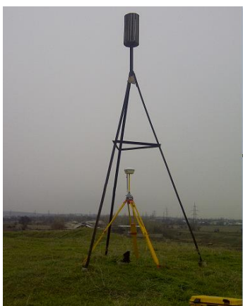
Рис.2. Опорный геодезический пункт
