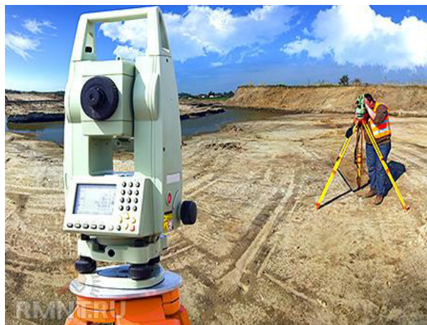
2 – расм Leica Nova MS50 замонавий электрон тахеометр
