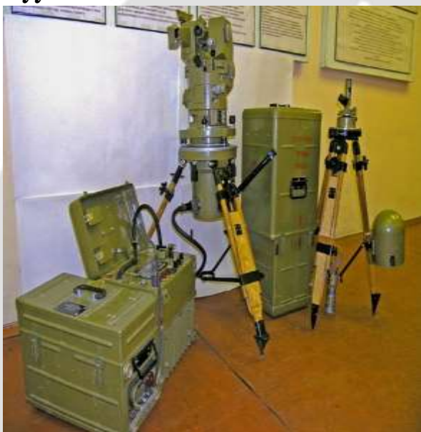
4-rasm. 1Г17 markadagi girokompas uskunasi
