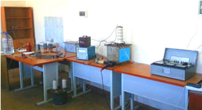
2-расм. Сувни зарарсизлантириш учун лаборатория электрогидравлик қурилмаси
