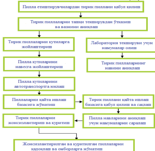
2-расм. Пиллани қайта ишлаш корхоналарига пиллага дастлабки ишлов бериш технологиясининг кетма-кетлиги.
